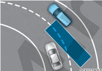
Система контроля «мертвых» зон может работать некорректно при движении по извилистой дороге. Система может не обнаруживать автомобиль на соседней полосе.
