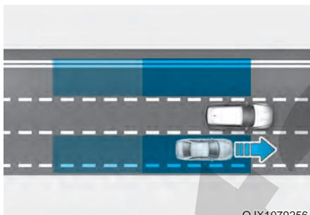
Вспомогательная система предотвращения столкновения в слепой зоне обнаруживает автомобиль в непросматриваемой зоне и предупреждает об этом водителя.
