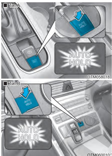
1. Закройте водительскую дверь, капот и дверь багажника (если автомобиль оснащен кнопкой переключения передач), нажмите педаль тормоза, а затем нажмите кнопку «AUTO HOLD» (Автоматическое удержание). Загорится белый индикатор «AUTO HOLD» (Автоматическое удержание), система перейдет в режим ожидания.
