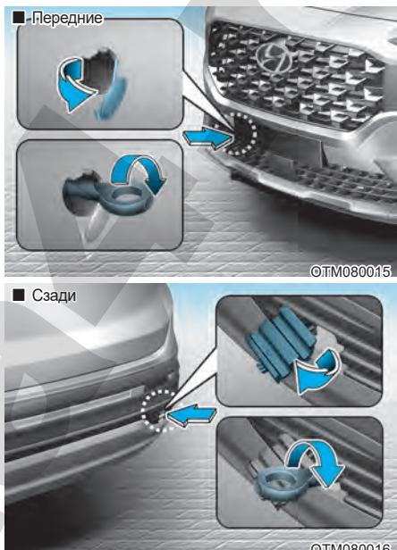
2. Снимите крышку с отверстия, нажимая на нижнюю часть крышки на бампере.
