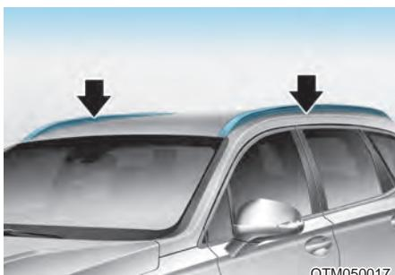
Если ваш автомобиль поставляется с рейлингами на крыше, то поверх их могут быть установлены поперечные балки.
