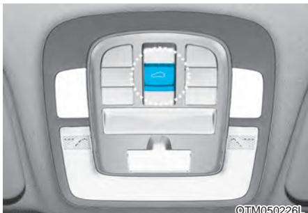
Для открытия или закрытия верхнего люка переключатель зажигания должен находиться в положении ON (ВКЛ).
