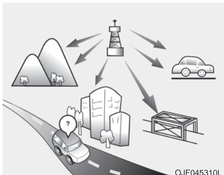
FM-радиосигналы передаются на высоких частотах и не следуют за профилем земной поверхности. По этой причине FM-сигналы начинают исчезать на небольшом расстоянии от радиостанции. Кроме того, на качество FM-сигналов могут влиять здания, возвышенности и другие препятствия. Это может приводить к созданию определенных условий прослушивания радио, в которых пользователь может подумать, что радиоприемник неисправен.
