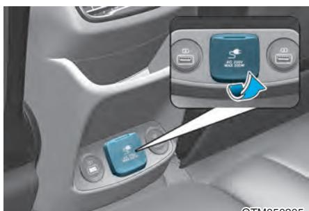
Инвертор для преобразования постоянного тока в переменный подает электроэнергию напряжением 220 В для работы электрооборудования и дополнительных устройств с общей потребляемой мощностью до 200 Вт.
