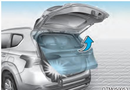
Если во время открытия или закрытия двери багажника датчик обнаруживает какое-либо препятствие, дверь багажника останавливается и начинает двигаться в противоположном направлении.
