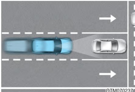
Вспомогательная функция предотвращения лобового столкновения помогает обнаруживать и отслеживать транспортные средства по ходу движения, обнаруживать пешеходов на проезжей части, а также предупреждает водителя о возможном столкновении с помощью сообщения и звукового оповещения и при необходимости применяет экстренное торможение.
