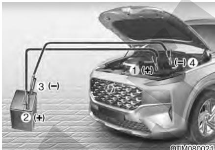
9. Запустите двигатель на транспортном средстве с заряженной батареей и дайте ему поработать несколько минут с частотой вращения 2000 об/мин. Затем запустите вашу машину.
