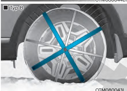
Ponieważ ścianki boczne opon radialnych są cieńsze, założenie niektórych rodzajów łańcuchów śniegowych może spowodować ich uszkodzenie. Z tego względu zaleca się korzystanie z opon zimowych zamiast łańcuchów śniegowych. łańcuchów śniegowych nie należy zakładać w pojazdach, które są wyposażone w felgi aluminiowe, ponieważ mogą one powodować uszkodzenia felg. Jeśli użycie łańcuchów śniegowych jest niezbędne, należy zastosować łańcuchy drutowe o grubości poniżej 15 mm.
