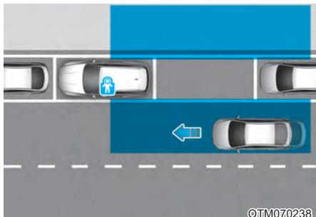
Если после остановки автомобиля и открытия пассажирской двери будет обнаружено приближающееся сзади транспортное средство, система контроля безопасного выхода предупредит водителя с помощью сообщения и звукового сигнала, чтобы предотвратить столкновение.
