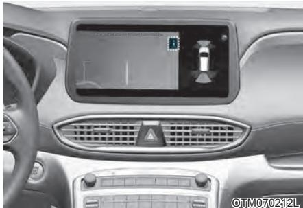
Если коснуться значка
