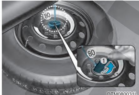
6. Проденьте направляющую фиксатора (1) через центральное отверстие запасного колеса.
