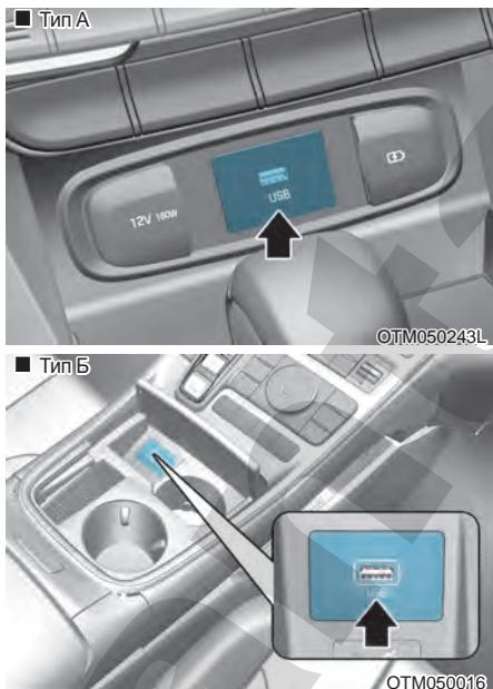
Для подключения аудиоустройств к автомобильному порту USB можно использовать USB-кабель.
