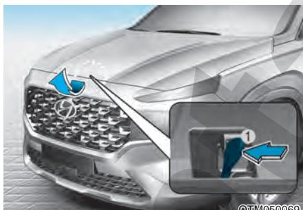
3. Подойдите к автомобилю спереди, приподнимите капот, поднимите вторичную защелку (1) по центру под капотом, а затем поднимите капот.
