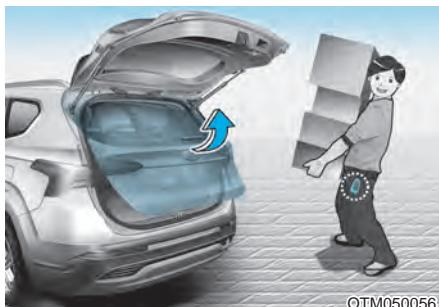
На автомобилях, оснащенных электронными ключами, багажник можно открыть без прикосновений с помощью системы автоматического открытия багажника.
