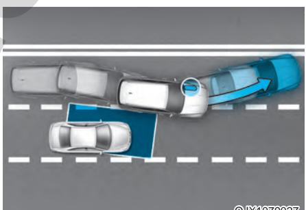
Если при перестроении существует риск столкновения с приближающимся транспортным средством в слепой зоне, система поможет избежать данного столкновения, определяя полосу движения впереди автомобиля и применяя торможение.
