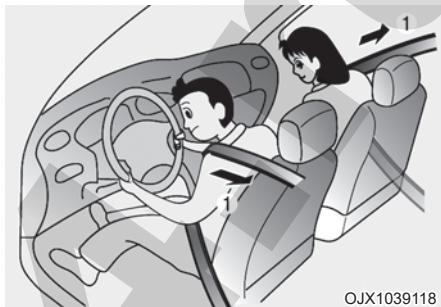
[1]: ремни безопасности с преднатяжителем втягивающего устройства
