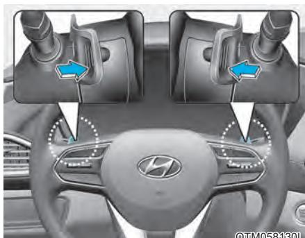
Подрулевыми переключателями скоростей можно пользоваться, если рычаг или кнопка переключения передач находятся в положении «D» (Передний ход) либо включен режим ручного переключения передач.
