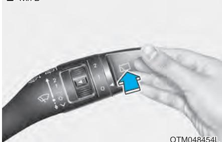
Отодвните рычаг от себя, чтобы распылить жидкость заднего омывателя и запустить задние стеклоочистители для 1 ~ 3 циклов. Разбрзгивание и работа стеклоочистителя будут продолжаться, пока вы не отпустите рычаг.
