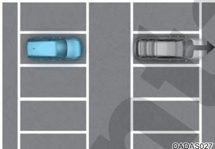
При отъезде припаркованного рядом с вами автомобиля, функция контроля отъезда впереди стоящего автомобиля может предупредить вас о том, что припаркованный автомобиль начинает движение.
