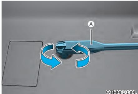
3. Поставьте колесный гаечный ключ (A) на болт.
