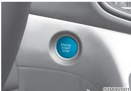
При открытии передней двери загорается кнопка «Engine Start/Stop» (Запуск/остановка двигателя). После закрытия двери она горит еще 30 секунд.
