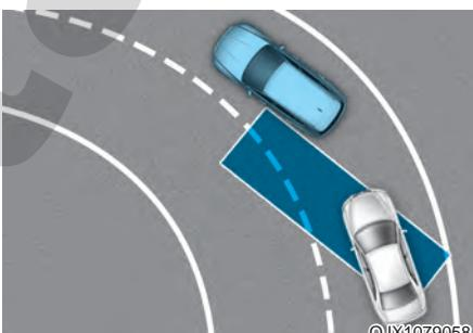
Система контроля «мертвых» зон может работать некорректно при движении по извилистой дороге. Система может распознавать автомобиль, движущийся в той же полосе, что и ваш автомобиль.
