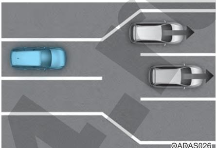
При движении через пункт сбора дорожной пошлины или через перекресток с большим количеством транспортных средств, а также при движении в местах, где полосы часто соединяются и разделяются, функция контроля отъезда впереди стоящего автомобиля может работать неправильно.
