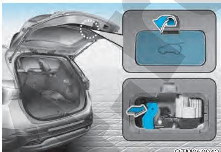
Автомобиль оснащен устройством аварийного открытия двери багажного отделения, которое находится в ее нижней части. При случайном запирании человека внутри багажного отделения. Необходимо выполнить следующие действия внутри багажного отделения:
