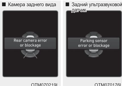
На приборной панели появится предупреждающее сообщение «Камера заднего вида заблокирована или не работает» или «Работа системы ограничена» в следующих случаях:
