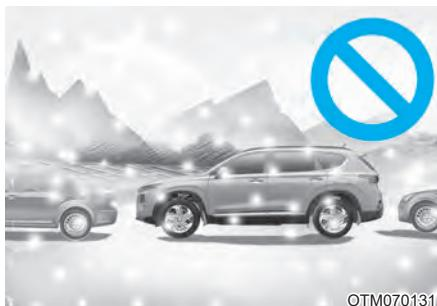
Снег может помешать работе датчиков в процессе парковки, а на скользкой дороге может быть отменена работа интеллектуальной системы дистанционной парковки.
