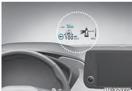
Проекционный дисплей — это дополнительная функция, позволяющая водителю просматривать информацию, которая проецируется на прозрачный экран. При этом глаза водителя не отвлекаются от дороги.
