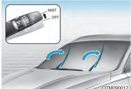
Этот автомобиль имеет конструкцию со «скрытым» стеклоочистителем. Это значит, что стеклоочистители нельзя поднять, когда они находятся в нижнем положении.
