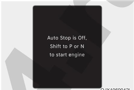
«Auto Stop is Off. Shift to P or N to start engine» (Автостоп выключен. Чтобы запустить двигатель, переведите рычаг переключения передач в положение «P» [Парковка] или «N» [Нейтраль])
