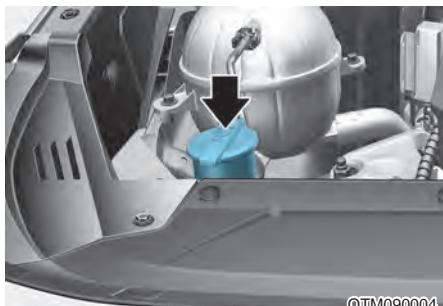
Проверьте уровень жидкости в бачке омывателя и долейте жидкость, если необходимо. При отсутствии жидкости омывателя можно использовать чистую воду. Однако в районах с холодным климатом следует использовать незамерзающие моющие растворы.
