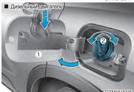
4. Потяните наружу лючок горловины топливного бака (1), чтобы добраться до крышки топливного бака.
