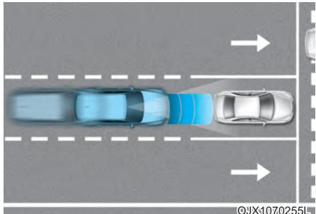
Система помощи по предотвращению переднего столкновения помогает обнаруживать и отслеживать транспортные средства по ходу движения, обнаруживать пешеходов или велосипедистов на проезжей части, а также предупреждает водителя о возможном столкновении с помощью предупреждающего сообщения и звукового оповещения и при необходимости применения экстренного торможения.
