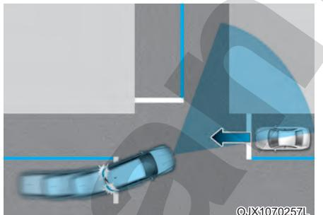
Функция Junction Turning (Поворот на перекрестке) применяет экстренное торможение, чтобы избежать столкновения со встречным транспортным средством, движущимся на соседней полосе, при его повороте на перекрестке налево с включенным сигналом поворота.
