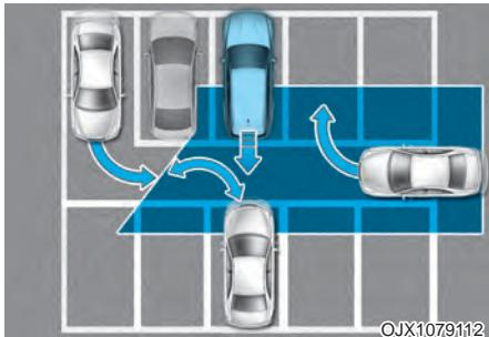
Система обеспечения безопасности при пересеченном движении сзади может обнаруживать транспортные средства, паркующиеся рядом с вашим автомобилем или отъезжающие от него (например, если транспортное средство, находящееся рядом с вашим автомобилем, отъезжает, паркуется или выезжает в область позади вашего автомобиля или если транспортное средство приближается к вашему автомобилю, выполняющему поворот, и т. п.). В этом случае система может без необходимости предупредить водителя.
