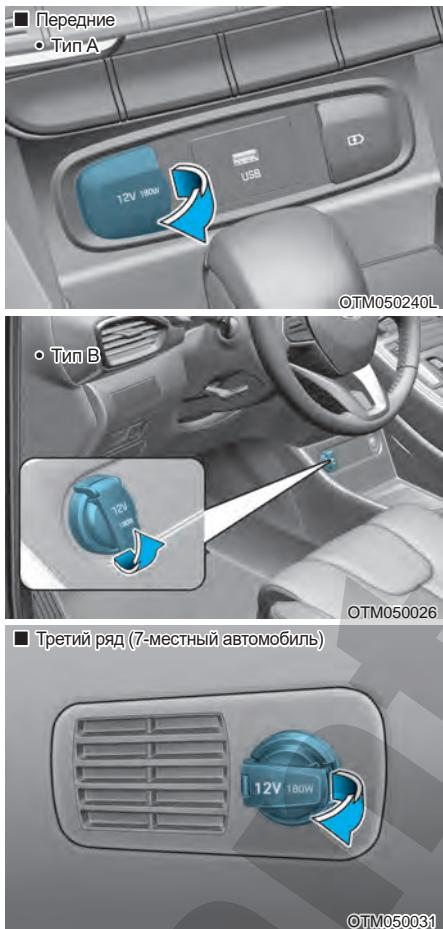
Розетка предназначена для подключения мобильных телефонов и других электроприборов, рассчитанных на питание от автомобильной электросистемы. При работающем двигателе электроприборы должны потреблять менее 180 Вт.
