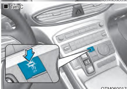
Если система выключена, светится индикатор кнопки «ISG OFF» (ISG выкл.) и на ЖК-дисплее приборной панели отображается сообщение «Auto Stop is off. Shift to P or N to start engine manually» (Автостоп выключен). Чтобы запустить двигатель, переведите рычаг переключения передач в положение «P» [Парковка] или «N» [Нейтраль]. Кроме того, звучит предупреждающий звуковой сигнал. В таком случае нажмите на педаль тормоза и повторно запустите двигатель в ручной режиме.
