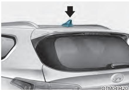
Антенна типа «акулий плавник» принимает передаваемые данные (например, AM и FM, DAB, GPS)
