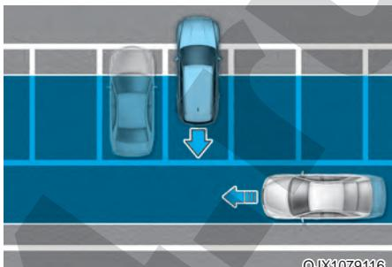
Система обеспечения безопасности при пересеченном движении сзади может обнаруживать транспортные средства, проезжающие сзади вас, когда вы паркуетесь задним ходом на парковочное место. Если это произойдет, система не всегда может выдавать предупреждение водителю и применять тормозную систему.
