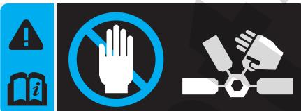
Электродвигатель вентилятора охлаждения двигателя может продолжать работать или включаться, когда двигатель не работает, что может привести к серьезным травмам. Держите руки, одежду и инструменты подальше от вращающихся лопастей вентилятора охлаждения.
