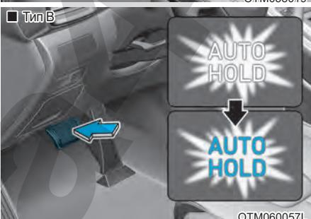
2. После полной остановки автомобиля с помощью педали тормоза функция «Auto Hold» (Автоматическое удержание) поддерживает давление в тормозной системе, чтобы удерживать автомобиль в неподвижном состоянии. Цвет индикатора сменится с белого на зеленый.
