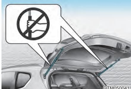
Не удерживайте деталь (газовый подъемник), которая поддерживает дверь багажника. Имейте в виду, что деформация этой детали может привести к повреждению автомобиля или травмам.
