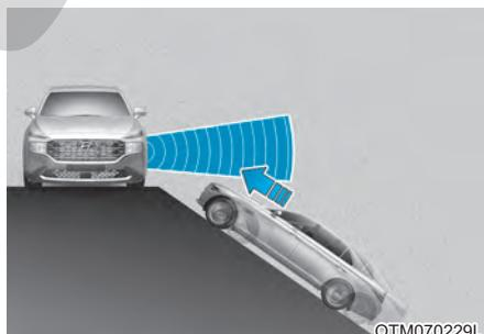
Система обеспечения безопасности при пересеченном движении сзади может быть ограничена при движении автомобиля на подъеме или спуске (или рядом с ними) и может не обнаружить транспортное средство, приближающееся слева и справа. В этом случае система может не предупредить водителя, когда это будет необходимо.
