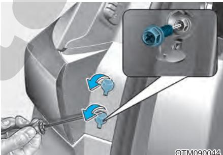
Стоп-сигнал/задний фонарь (внешний), фонарь заднего хода
