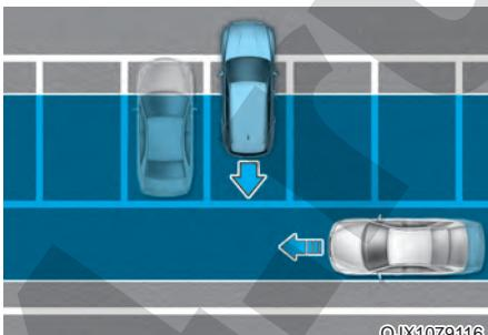
Система обеспечения безопасности при пересеченном движении сзади может обнаруживать транспортные средства, проезжающие сзади вас, когда вы паркуетесь задним ходом на парковочное место. В этом случае система может без необходимости предупредить водителя.
