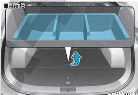
Здесь можно хранить аптечку, знак аварийной остановки (передний лоток), инструменты и др.
