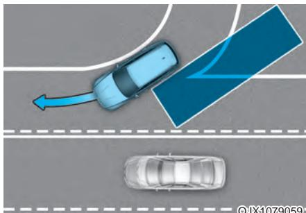
Система контроля «мертвых» зон может работать некорректно при движении в местах соединения или разделения дорог. Система может не обнаруживать автомобиль на соседней полосе.
