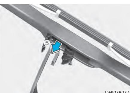
3. Снимите щетку стеклоочистителя с его рычага.
