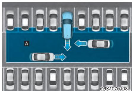
[A]: рабочий диапазон системы оповещения об объектах, движущихся в поперечном направлении сзади автомобиля
