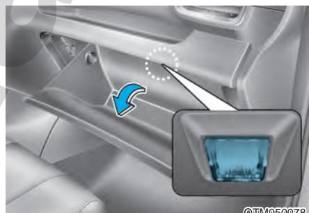
Лампа перчаточного ящика включается при его открытии.
