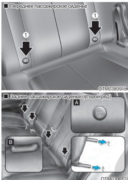
[A]: указатель местоположения анкерного крепления ISO FIX
