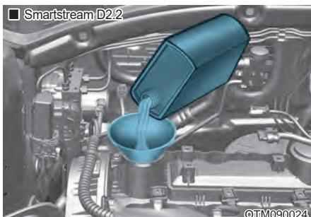
Если уровень в диапазоне «D», долейте достаточно моторного масла, чтобы поднять его до диапазона «C».
