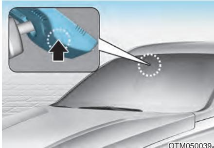
Система автоматического предотвращения запотевания уменьшает вероятность запотевания внутренней поверхности ветрового стекла, автоматически обнаруживая влагу на внутренней поверхности ветрового стекла.
