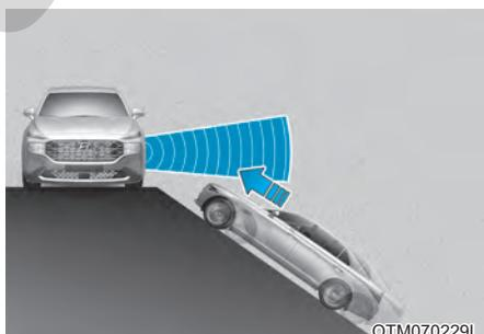
Система обеспечения безопасности при пересеченном движении сзади может быть ограничена при движении автомобиля на подъеме или спуске (или рядом с ними) и может не обнаружить транспортное средство, приближающееся слева и справа. Если это произойдет, система может не предупредить водителя или не применить тормоза, когда это будет необходимо.
