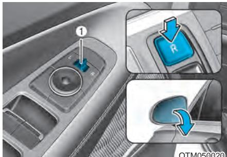
Если установить рычаг переключения передач в положение «R» (задний ход), наружные зеркала заднего вида наклонятся вниз, способствуя управлению при движении задним ходом.
