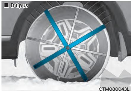
Mivel a radiál gumiabroncsok oldalfala vékonyabb, megsérülhetnek bizonyos fajtájú hólánc felszerelésétől. Ezért inkább javasoljuk a téli gumiabroncsok használatát, mint a hólánc használatát. Ne szereljen fel hóláncot alumínium keréktárcsás kerékre, mivel a hólánc sérüléseket okozhat a keréktárcsán. Ha mégis hóláncot kellene használnia, használjon 15 mm-es átmérőnél kisebb, kábeltípusú hóláncot. Gépkocsijának a hólánc helytelen használatából eredő káraira nem vonatkozik a garancia.
