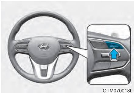
Чтобы отключить систему ручного контроля за ограничениями скорости, нажмите кнопку «Driving Assist» (MODE) (Помощь при вождении). Индикатор включения системы ручного контроля за ограничениями скорости ( $\text{LIMIT}$ ) погаснет.
