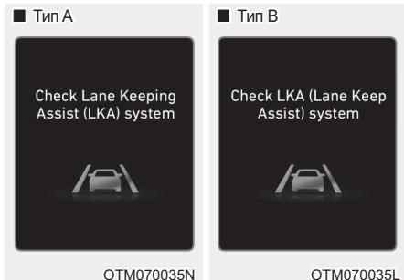
Если система удержания полосы не работает должным образом, появится предупреждение «Проверить LKA (удерживание полосы)» и на приборной панели загорится желтый
