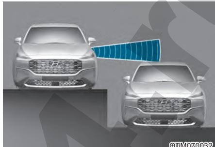
Система контроля «мертвых» зон может работать некорректно при движении в местах, где полосы расположены на разной высоте. Система может не обнаруживать автомобили, движущиеся по дорогам с разной высотой полос (проезды под железнодорожными мостами, разноуровневые дорожные развязки и т. д.).
